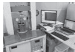
CBR試験状況
