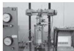
三軸圧縮試験状況
