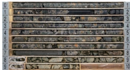
写真-2 採取コア状況 (コアドリル)
