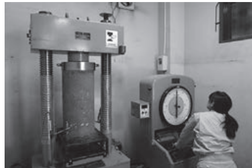
CSG工法（圧縮強度試験 径300mm）試験状況
