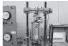
三軸圧縮試験状況
